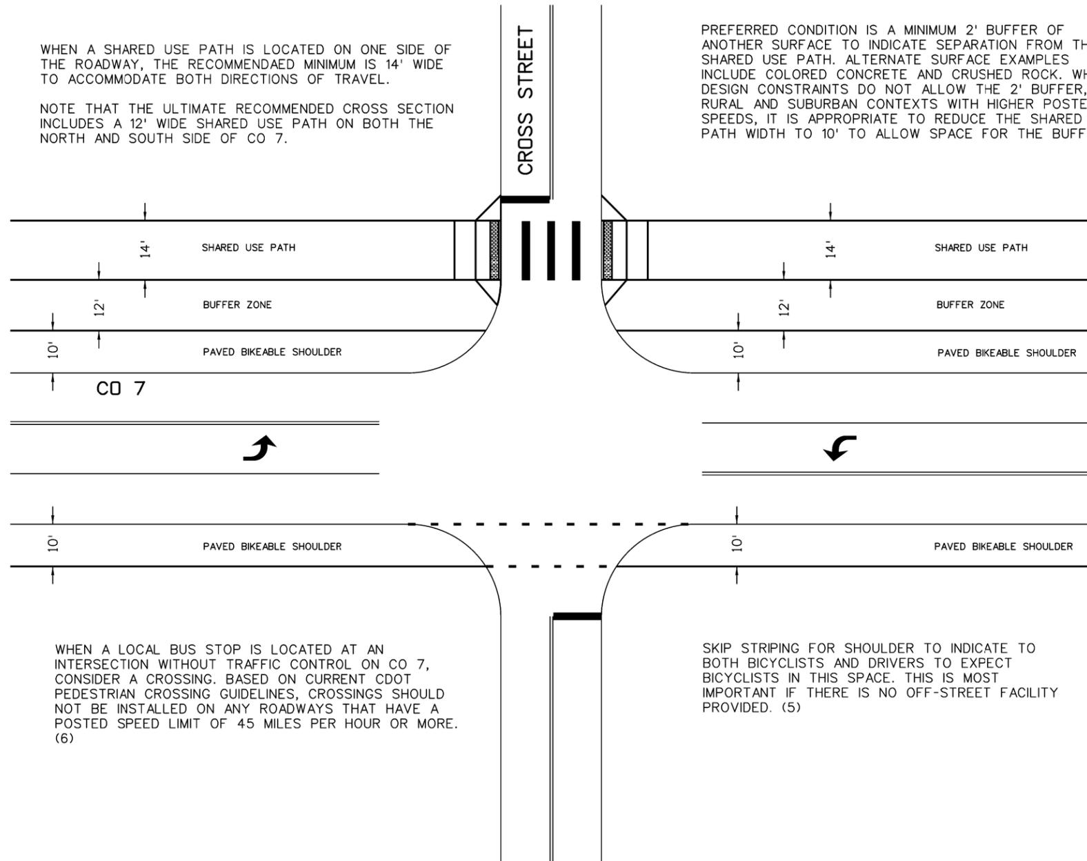
WHEN A SHOULDER IS PROVIDED, IT SHOULD BE ASSUMED THAT SOME BICYCLISTS WILL UTILIZE THIS AS AN ON-STREET FACILITY. FOR THIS REASON, THE SHOULDERS SHOULD BE PAVED. THE FWHA BIKEWAY SELECTION GUIDE WAS CONSULTED IN THE RECOMMENDED WIDTH FOR SHOULDERS. THE MINIMUM WIDTH IS 5' AND THE MAXIMUM WIDTH IS 10'. (7)
